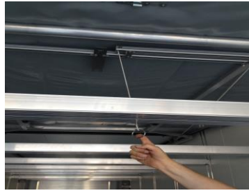
Arretierungsbolzen durch Ziehen der Schnur entriegeln
