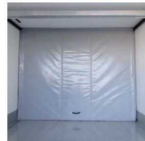
Trennwand in senkrechte Position bringen
