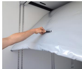
Trennwand von Hand bis zum Anschlag herausziehen, bis Trennwand selbstständig herunterklappt.
