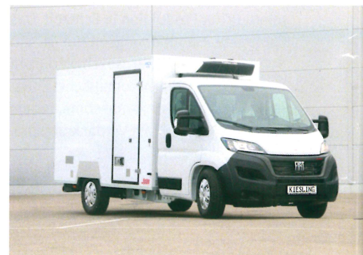
Beispiel eines City Runner auf Fiat Ducato-Basis mit Thermo King V600x Kühlaggregat.
